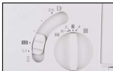
Lehce přístupné ovladače délky stehu a diferenciálu
