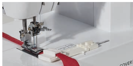
Zakladač pro šití poutek, hotová šířka 11mm
